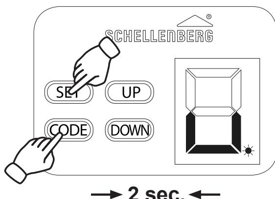
DE Betätigen Sie beide Tasten für 2 Sekunden gleichzeitig.
