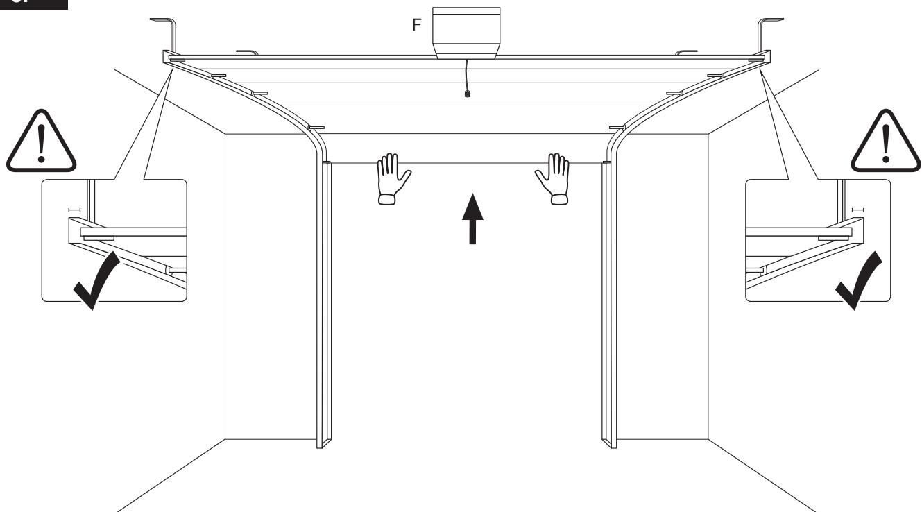
**DE** Schieben Sie das Garagentor in die höchstmögliche Endposition. Vorsicht, wenn der Laufweg der Rollen des Garagentores nicht gesichert ist, kann das Tor herunterfallen!
