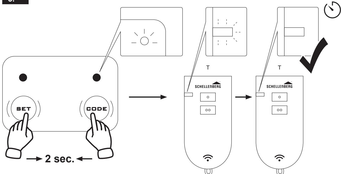
**DE** Betätigen Sie beide Tasten für 2 Sekunden gleichzeitig.
