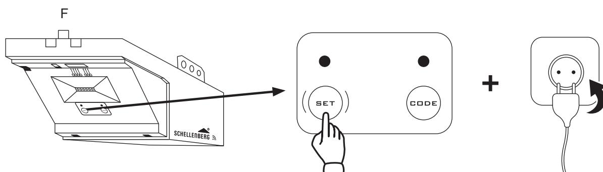
**DE** Drücken Sie die Taste „Set“ und halten Sie die Taste gedrückt. Währenddessen stecken Sie den Stecker des Garanteriorantriebs in die Steckdose.
